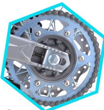
АЛЮМИНИЕВАЯ ФРЕЗЕРОВАННАЯ ВЕДОМАЯ ЗВЕЗДА 47 ЗУБЬЕВ
